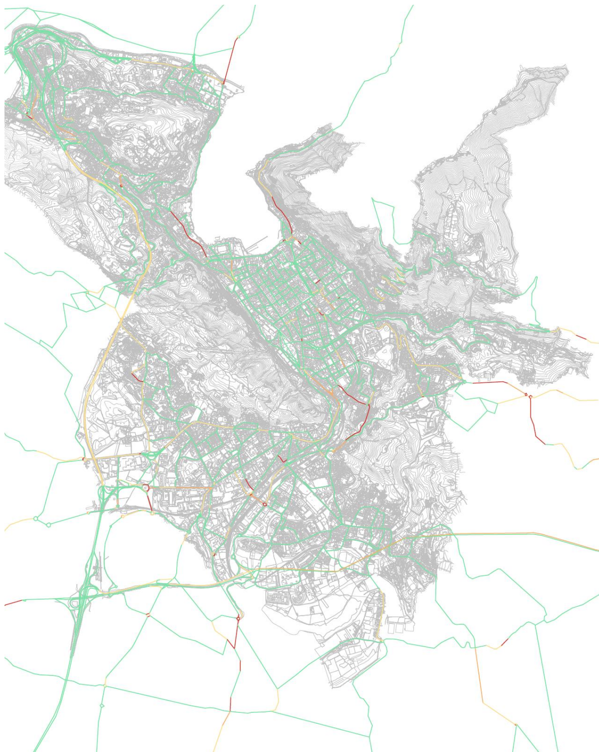
Figura 53 -Scenario di medio lungo termine ora di punta del mattino (7:30-8:30) - Rapporto tra volumi di traffico (in veicoli equivalenti) e capacità delle strade (rapporto V/C)
