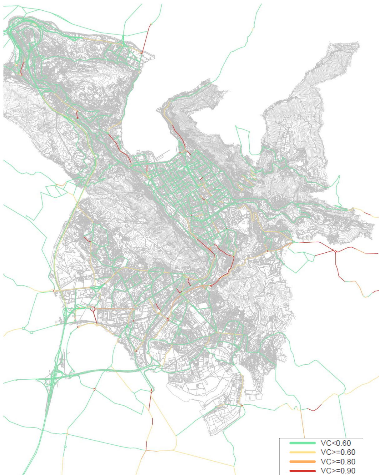
Figura 50 - Scenario di breve termine ora di punta del mattino (7:30-8:30) - Rapporto tra volumi di traffico (in veicoli equivalenti) e capacità delle strade (rapporto V/C)
